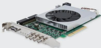
**imaFlex CXP-12 Quad** è un frame grabber CXP-12 completamente programmabile. Quando è collegato all'alimentazione del computer, imaFlex CXP-12 Quad supporta Power over CXP (PoCXP).
